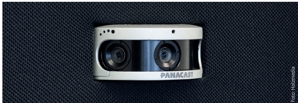
Zur Aufnahme der VC-Teilnehmer dient eine unauffällig integrierte 180°-Kamera, deren 3-Linsen-System auch schwierige Räume gut erfasst.
